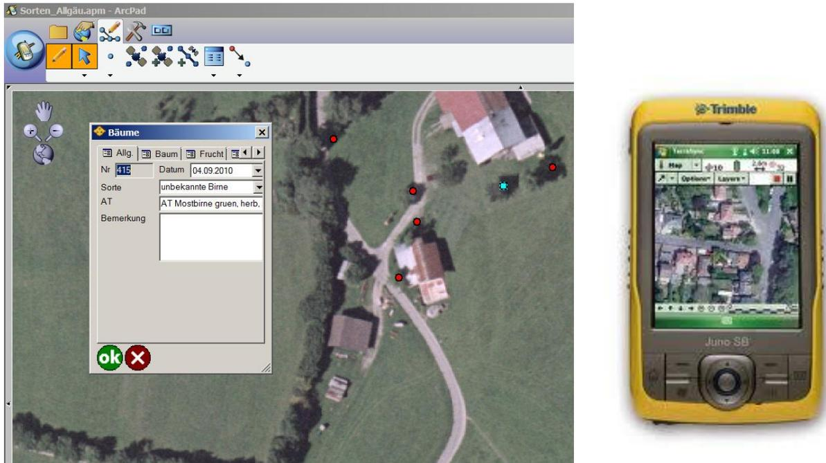
Abbildung 3: Datenerfassungsmaske für die Geländeaufnahme mit Juno SB von Trimble
